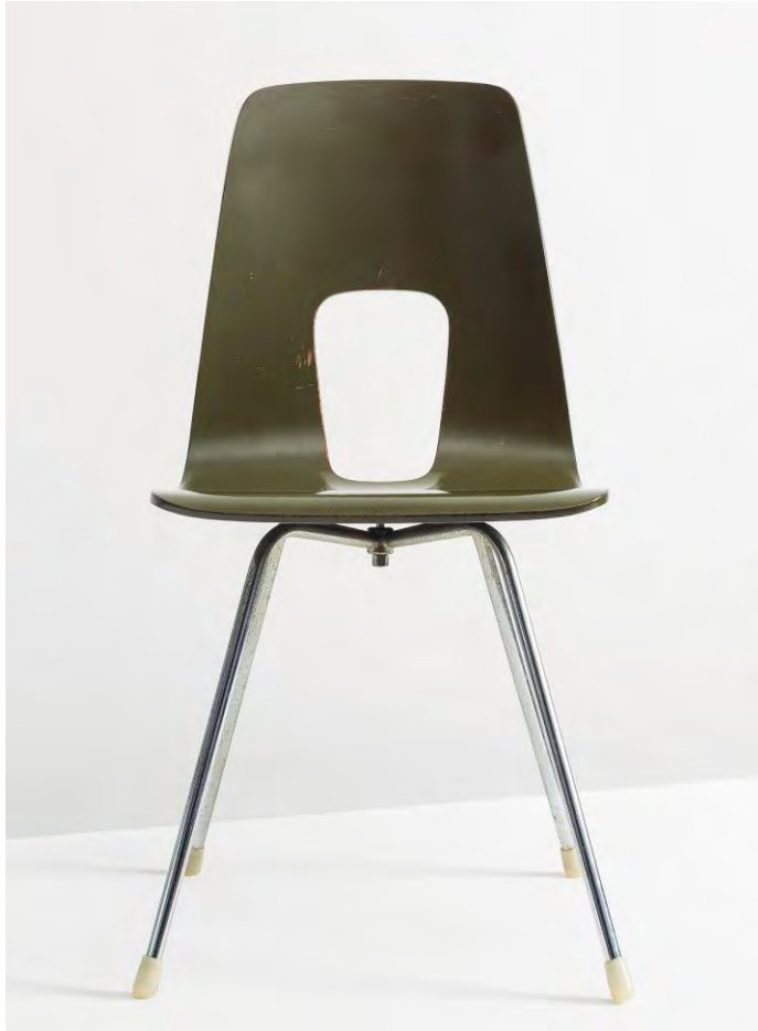
Mit einer einzigen zentralen Schraube wird die Formholzschale mit dem Untergestell verbunden. Selbstentworfene GummifüÙe verhindern das Verrutschen.
