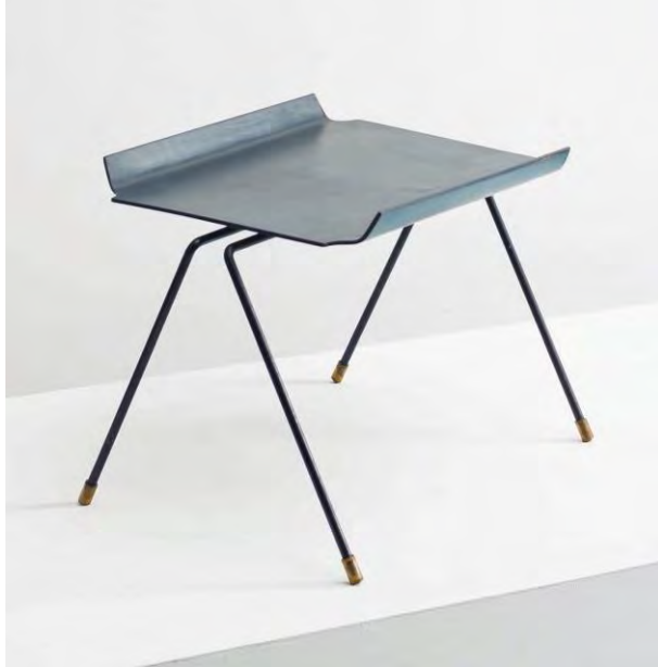
Stapelbarer Tisch, Höhe 46 cm, Formanerholzplatte 53 x 42,5 cm, Füße Stahlrohr, meist schwarz, matt, emailliert oder seltener verchromt. Das Blatt wird aus Pressholz wasserfest verleimt, poliert, in Birke, Esche, Ahorn, Mahagoni oder Nussbau sowie in diversen Farben lackiert bei Horgenglarus als Modell 7030 und bei Domus (BRD) als Modell 701 erhältlich. Eigens entworfene Gummifüßchen schützen vor ungewolltem Verrutschen beim Be- und Entladen des sehr leichten Tischchens.
