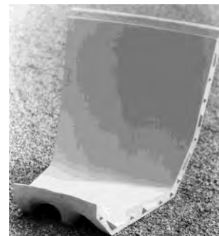
In die fertiggestellten Gipsformen wurde das neu entwickelte Stracolle, ein von der Firma Strässle Söhne AG entwickeltes glasfaserverstärktes Material auf Polyesterbasis, eingebracht. Links für die grösseren Formen der Sofas mussten mehrere Einzelteile zusammengesetzt werden. Fotograf unbekannt, Archiv Rosmarie Bellmann, Wiggwil.
