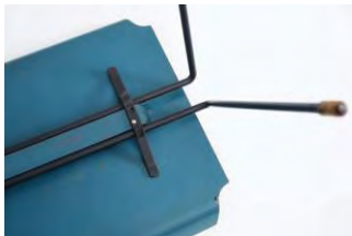
Stapelbarer Tisch, Höhe 46 cm, Formanerholzplatte 53 x 42,5 cm, Füße Stahlrohr, meist schwarz, matt, emailliert oder seltener verchromt. Das Blatt wird aus Pressholz wasserfest verleimt, poliert, in Birke, Esche, Ahorn, Mahagoni oder Nussbau sowie in diversen Farben lackiert bei Horgenglarus als Modell 7030 und bei Domus (BRD) als Modell 701 erhältlich. Eigens entworfene Gummifüßchen schützen vor ungewolltem Verrutschen beim Be- und Entladen des sehr leichten Tischchens.
