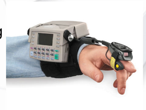
Bild: Mobiles High-Tech Lesegerät kombiniert für Bare-Code, Smart-Code, RFID und OCR Schriften des US-Zolles.
